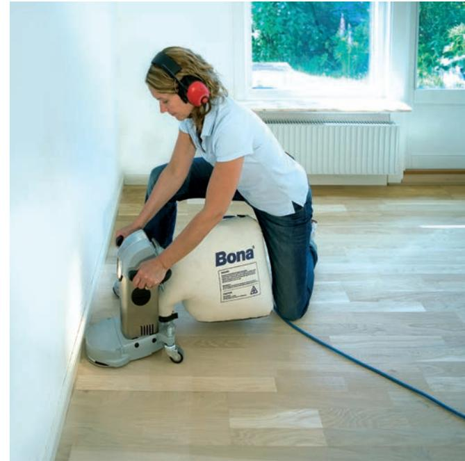
Der Randschleifer ist zum Schleifen von Fußbodenrändern, Nischen, Ecken und Treppen besonders gut geeignet, da die integrierte leistungsstarke Leuchte das Schleifen selbst an schlecht sichtbaren Stellen ermöglicht. Zudem verfügt dieser Randschleifer über eine sehr wirksame Staubabsaugung und eine elektronische Anlaufstrombegrenzung.
