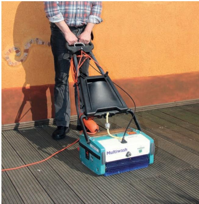
Der Bürstenreiniger ist besonders für die Auffrischung von Holz-Terrassenböden wie z. B. Bangkirai geeignet und kann des Weiteren auch zur Reinigung stark beanspruchter Industrie- und Gewerbeböden eingesetzt werden.
